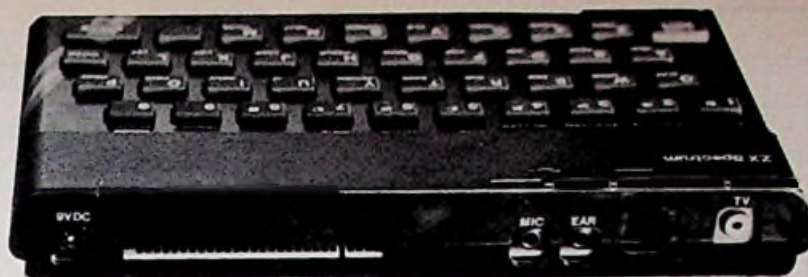
Afb. 2 Aansluitingen op achterzijde voor uitbreidingen, cassette-recorder, voeding en televisie.
