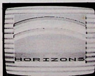
Afb. 3 t.e.m. 5 Voorbeelden van de videomogelijkheden. De strepen in de rand van afb. 5 zijn veroorzaakt door data, op dat moment ingelezen van de cassette-recorder.
